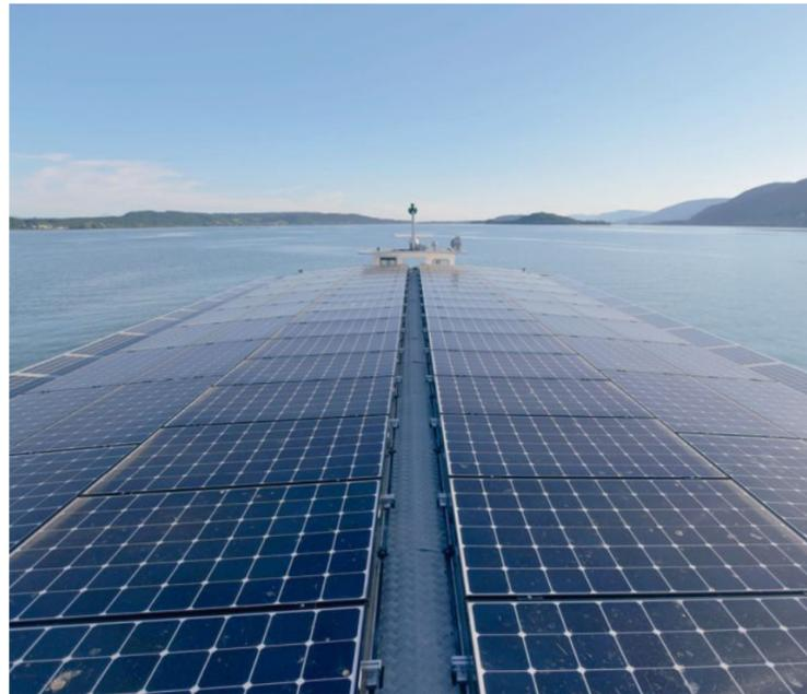
**85 Prozent des Stroms**, der auf dem Schiffsdach des Solarkatamarans Mobicat produziert wird, wird ins Stromnetz eingespeist. ZVG/SCHWEIZER SOLARPREIS 2019
